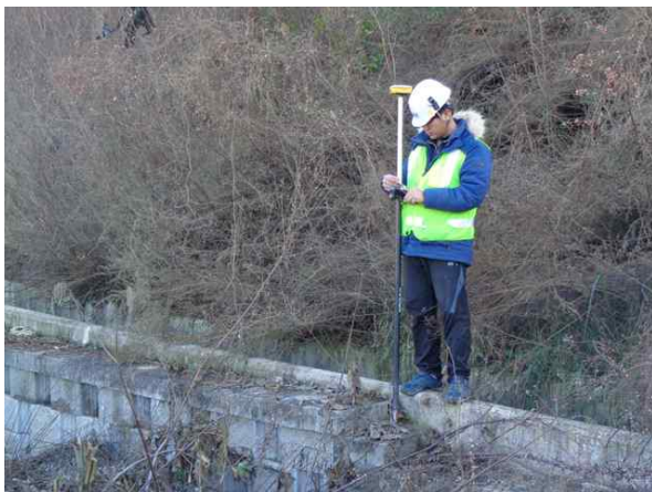
GPS측량기를 이용한 측량 작업
