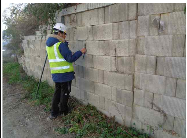
경사계를 이용한 경사도 측정
