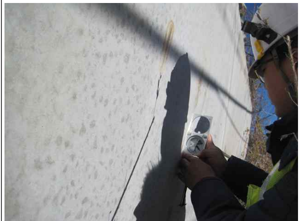
경사계를 이용한 경사도 측정
