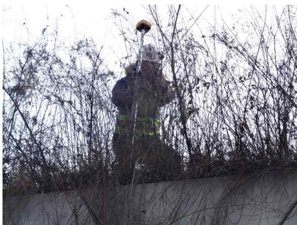
GPS측량기를 이용한 측량 작업
