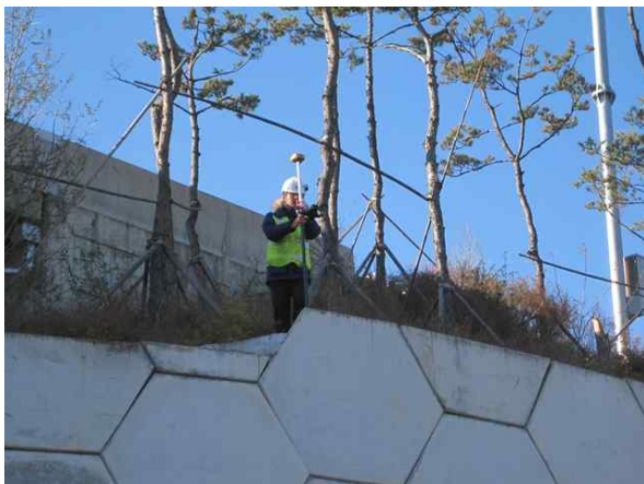
GPS측량기를 이용한 측량 작업
