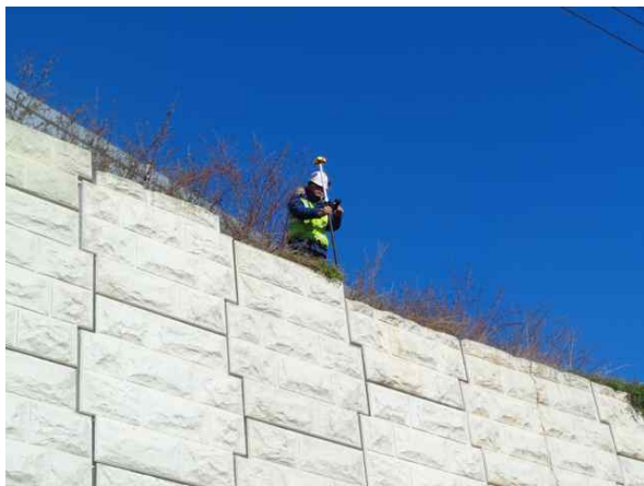
GPS측량기를 이용한 측량 작업
