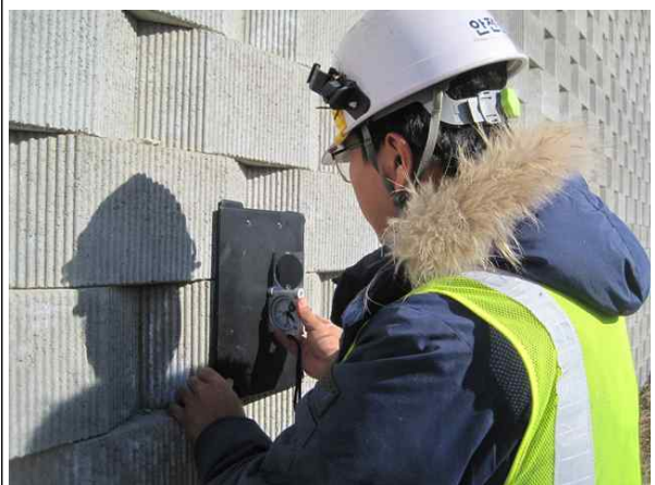
경사계를 이용한 경사도 측정
