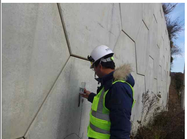
경사계를 이용한 경사도 측정
