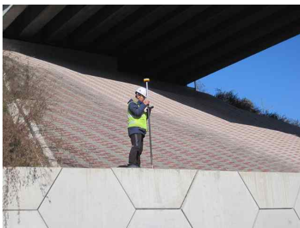
GPS측량기를 이용한 측량 작업
