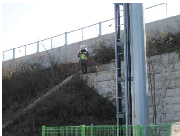
GPS측량기를 이용한 측량 작업
