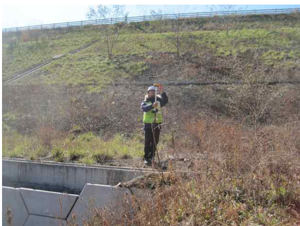
GPS측량기를 이용한 측량 작업
