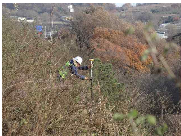
GPS측량기를 이용한 측량 작업
