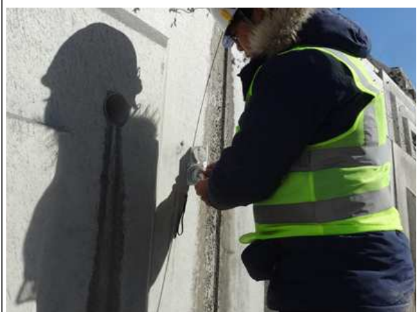
경사계를 이용한 경사도 측정
