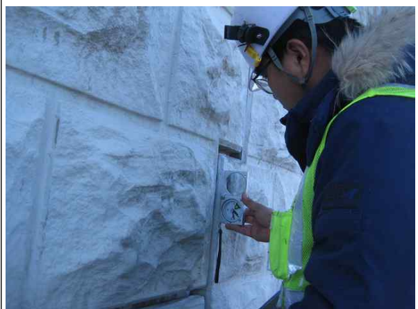
경사계를 이용한 경사도 측정
